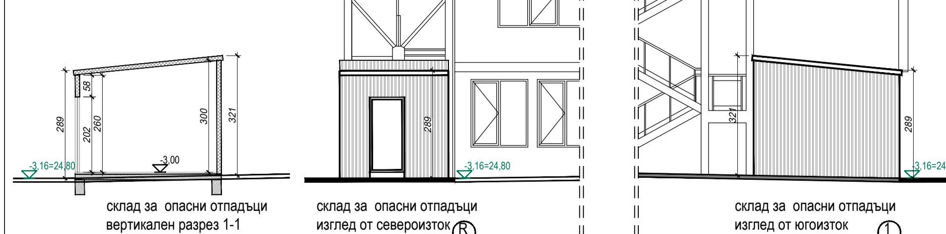
ПРИСТРОЙКА - склад за предварително съхранение на опасни отпадъци - вертикален разрез и изглед
