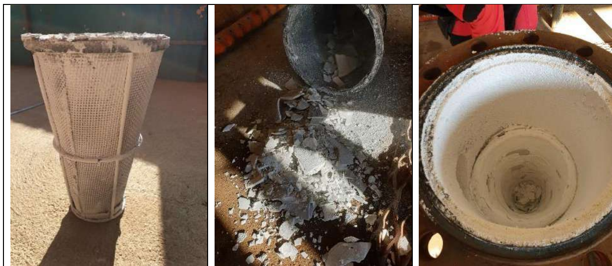
Фигура 25 Снимки на филтрите на помпите за LPG от секцията за стабилизация на реформата.
