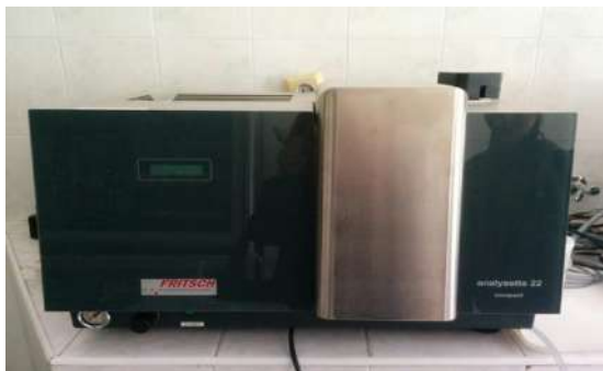
Снимка 2. Апарат за лазерен дифракционен анализ Analysette 22.
