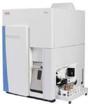
Снимка 3. Индуктивно свързана плазма със спектрометър ICP-MS
