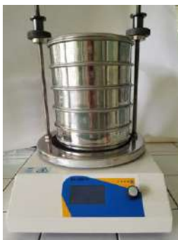
Снимка 1. Вибрационна машина CISA VA200N със сита.
