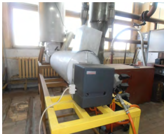
Фиг. 18. Фотография на горелка LPG - WEISHAUPТ- WG 5 F/1-A LN 1/2", монтирана на системата за разграждане на медна шлака.
