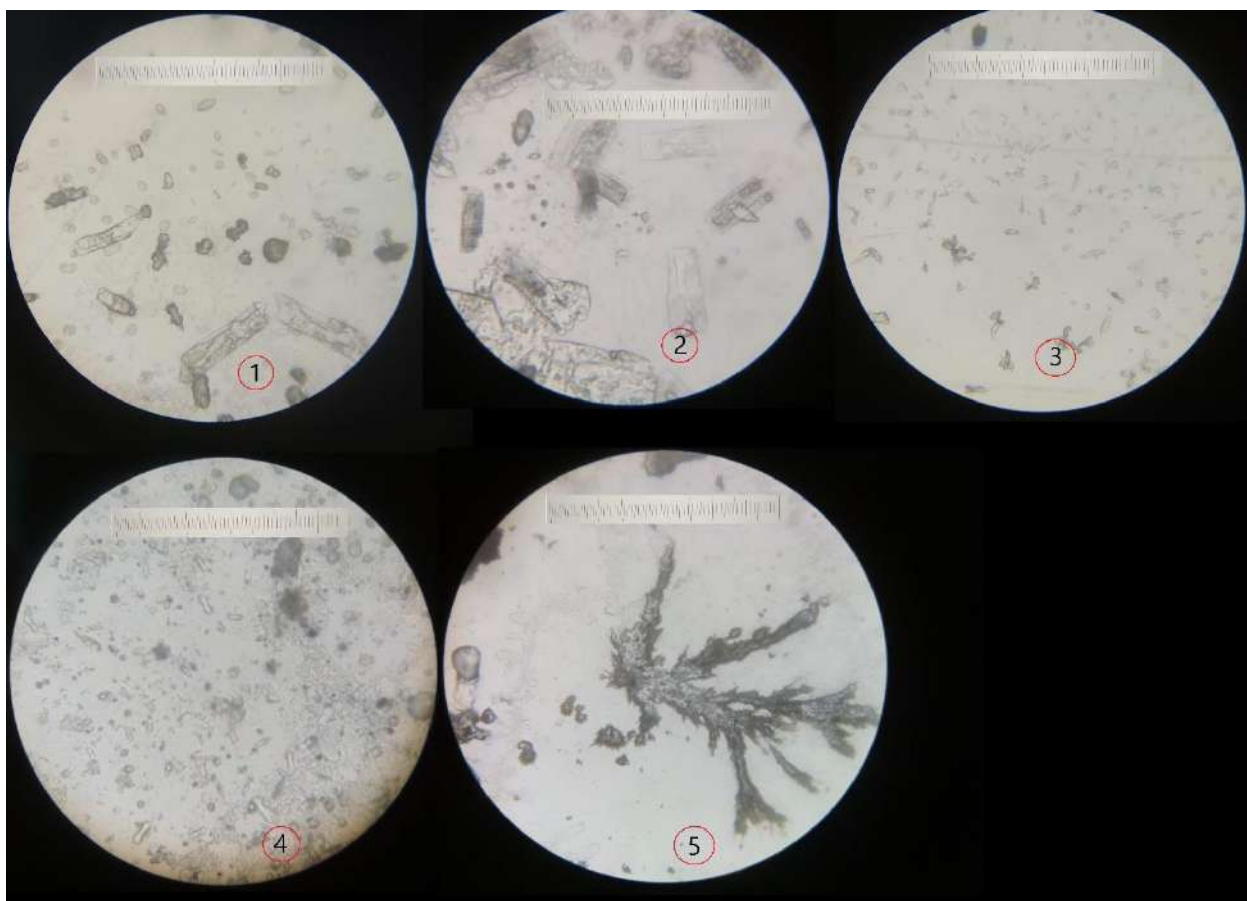
Фигура III-30 Снимки на утаени кристали (светлинен микроскоп) от ОВ от свинеферма SS2-събирател
