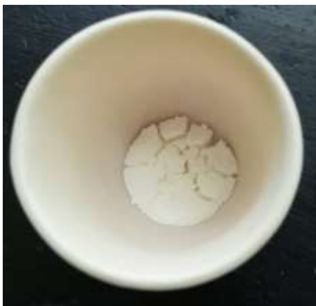
Фиг. 1. Прах от бариев титанат получен след изпичане при 800^\circ\text{C}
