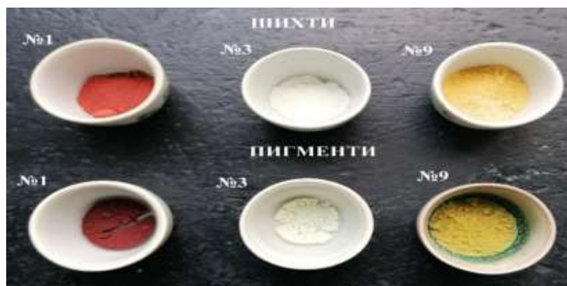
Фиг. 1. Изходни шихти (горен ред) и изпечени пигменти при 1000^\circ C (долен ред)
