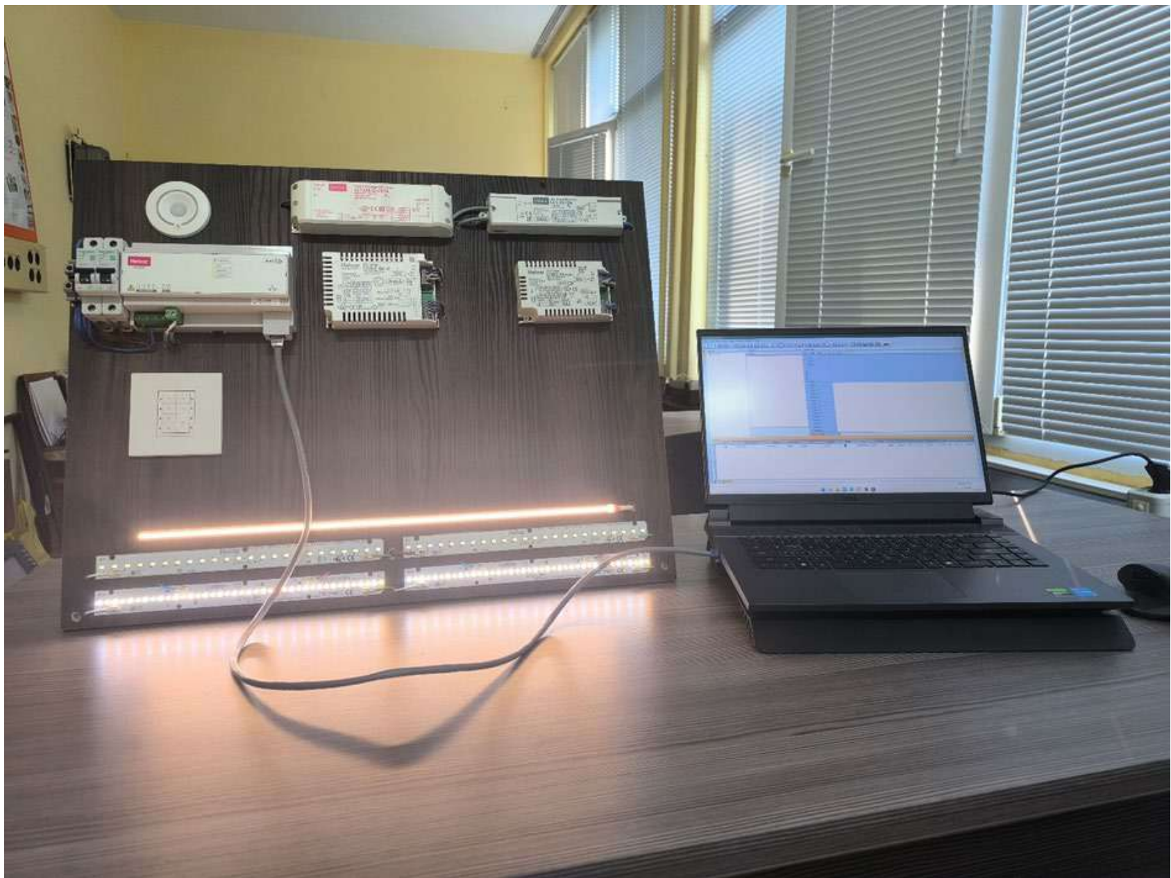
Фиг. 3. Програмиране на макет за интелигентно управление на осветление (интерфейс DALI – 2).
