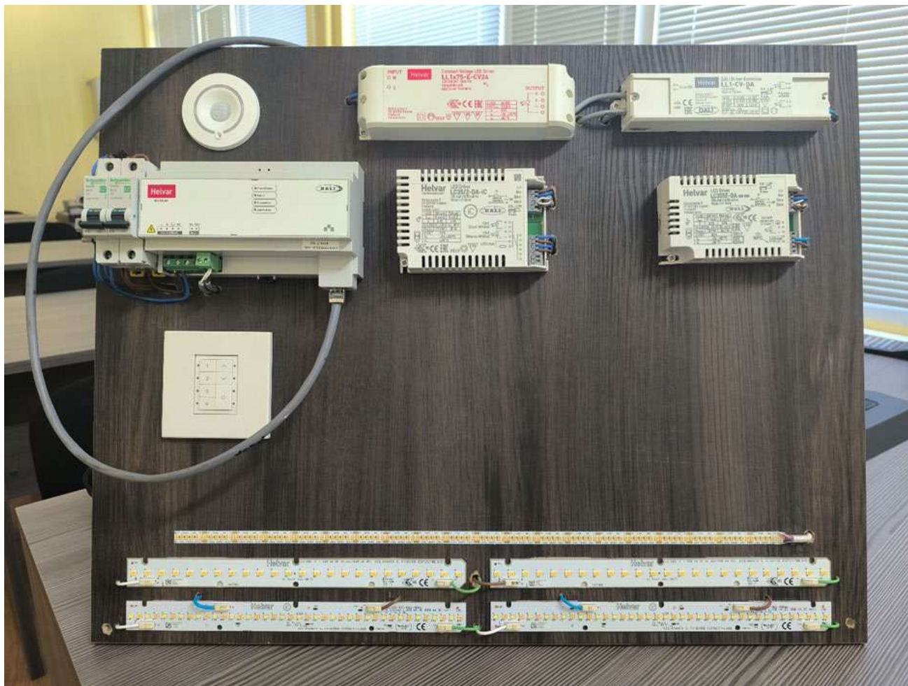
Фиг. 2. Макет за интелигентно управление на осветление (интерфейс DALI–2).
